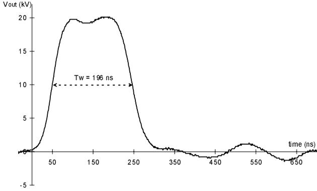
**Fig. 4.** Blumlein output voltage ( $d/w \approx 0.21$ ;  $L = 16$  nH;  $3.3 \Omega$ ).
